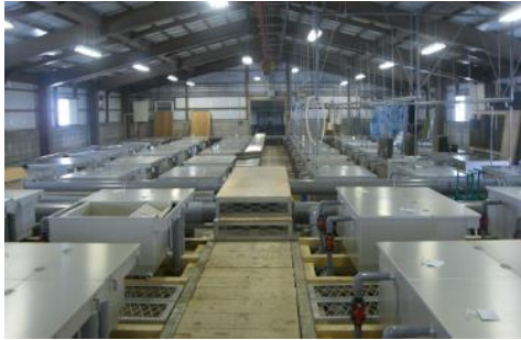
写真5 瀬棚ふ化場の浮上槽(アルミ)
