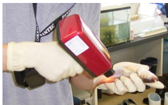
近赤外分光光度計による簡易計測
